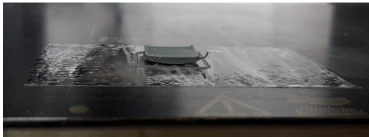
Fig. 6 Polypropylene (PP) transparent bed layer
