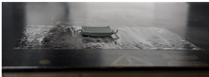
Fig. 6 Polypropylene (PP) transparent bed layer
