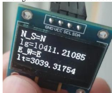
Fig. 7 OLED display test
